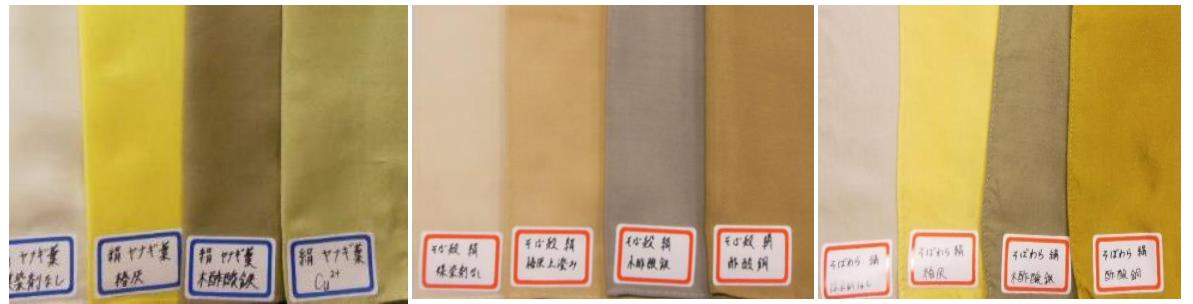
Fig.4 媒染剤を用いた染色試験の結果(左からオノエヤナギ、そば殻、そば藁)
